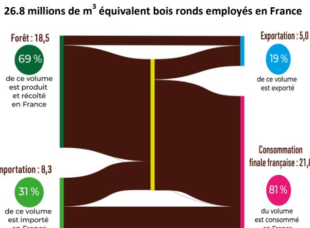
Les flux de bois d'œuvre, représentés dans ce diagramme de Sankey, illustrent le parcours du matériau de bois d'œuvre depuis l'amont jusqu'à l'aval de la filière. On y observe que 18,5 Mm<sup>3</sup> de bois d'œuvre utilisés en France proviennent directement des forêts françaises, tandis que 8,3 Mm<sup>3</sup> sont issus de l'importation.
