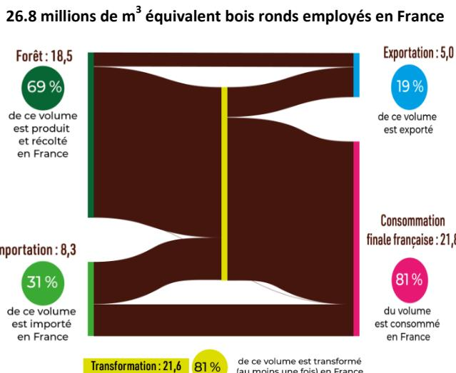
Les flux de bois d'œuvre, représentés dans ce diagramme de Sankey, illustrent le parcours du matériau de bois d'œuvre depuis l'amont jusqu'à l'aval de la filière. On y observe que 18,5 Mm<sup>3</sup> de bois d'œuvre utilisés en France proviennent directement des forêts françaises, tandis que 8,3 Mm<sup>3</sup> sont issus de l'importation.
